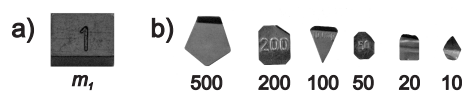
Abbildung 1: Gewichte: a) unbekannt Masse m_1 ; b) Form und Gewicht (in Milligramm) der kleinen Masseplättchen
