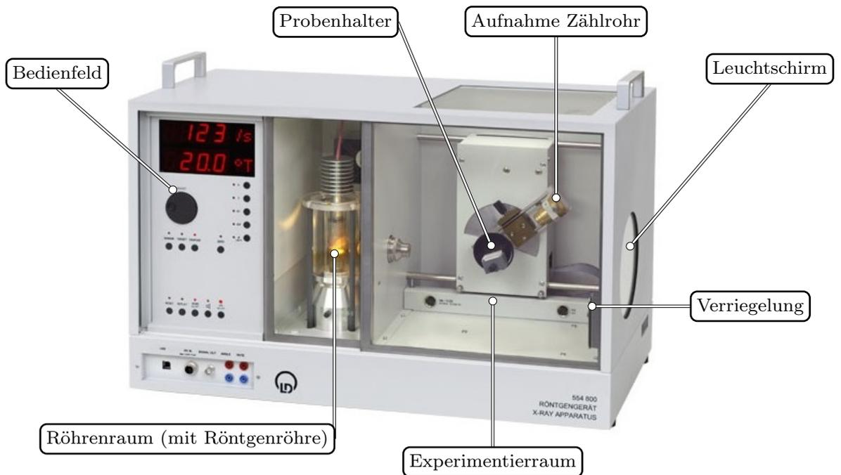
**Abbildung 1.30:** Mikroprozessorgesteuertes Vollschutzgerät mit Mo-Röhre und Goniometer
