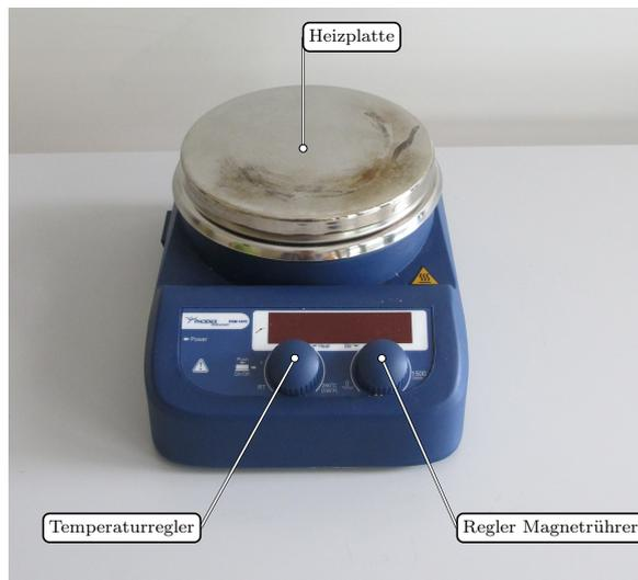
**Abbildung 1.22:** Heizplatte RSM-10HS
