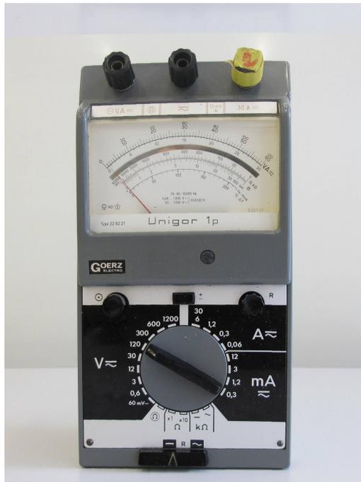
**Abbildung 1.20:** Analoges Multimeter Unigor 1p
