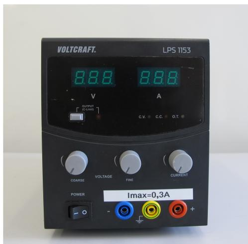
Abbildung 1.18: Netzgerät LPS 1153
