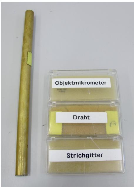
**Abbildung 1.13:** Kupferrohr mit Mattscheibe (links), Kästchen mit Objektträgern mit Objektmikrometer, Draht und Strichgitter
